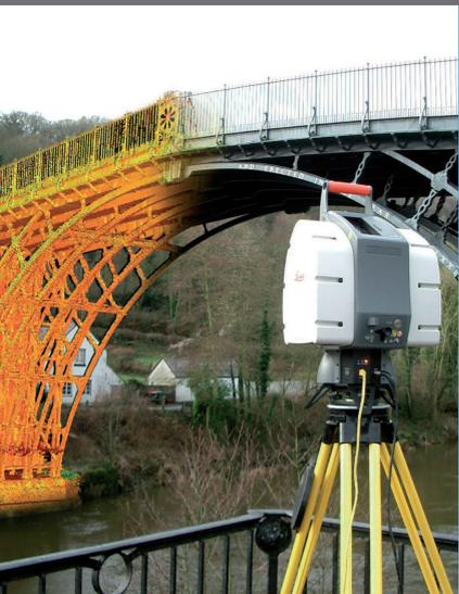
Toma de datos tridimensionales con escáner láser
